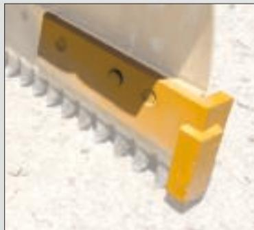
Los protectores de extremos también se encuentran disponibles para trabajos en condiciones arduas. Las brocas para protección de extremos, elaboradas con acero endurecido y diseñadas para trabajos pesados, proporcionan una combinación exclusiva de ductilidad y acero templado.
